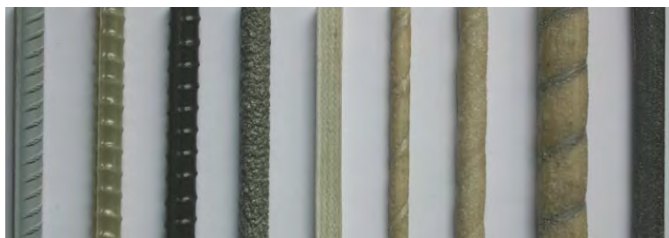
Slika 1. Tipovi FRP šipki Figure 1. Types of FRP bars
